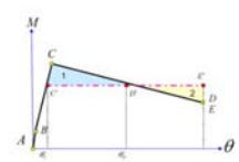
圖 002-2 剪力破壞塑鉸之修正形式
