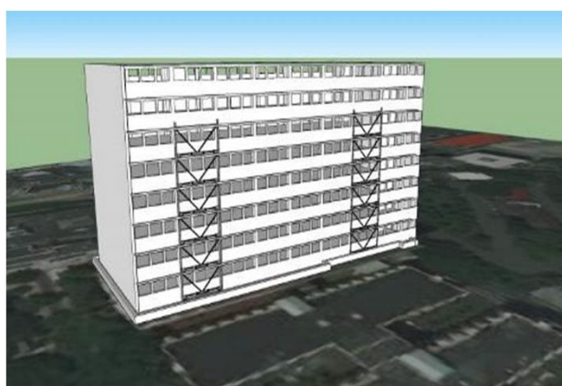
液流阻尼器外框補強
